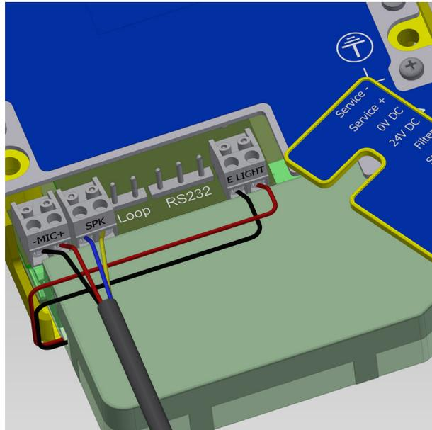
Die folgenden Verbindungen sind erforderlich zum 20-fach Anschlussblock des Memcom Gerätes
