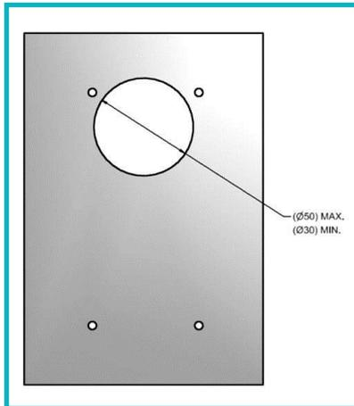
**2. Bohren Sie Befestigungslöcher**
