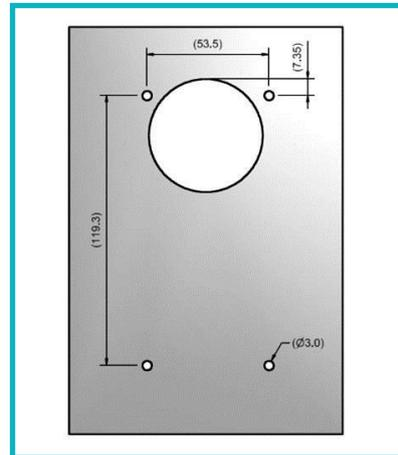
**3. Führen Sie das Kabel durch das große Loch**
