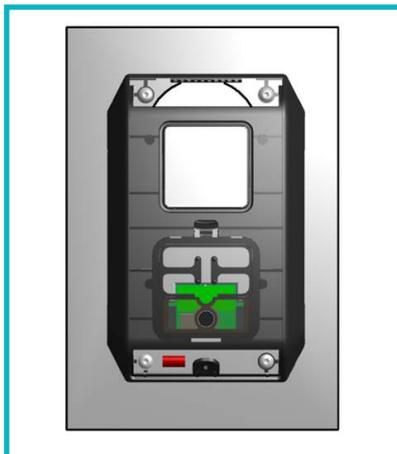
**5. Stecken Sie die Lasche der Metallplatte in die Aussparung oben am Kunststoffgehäuse.**
