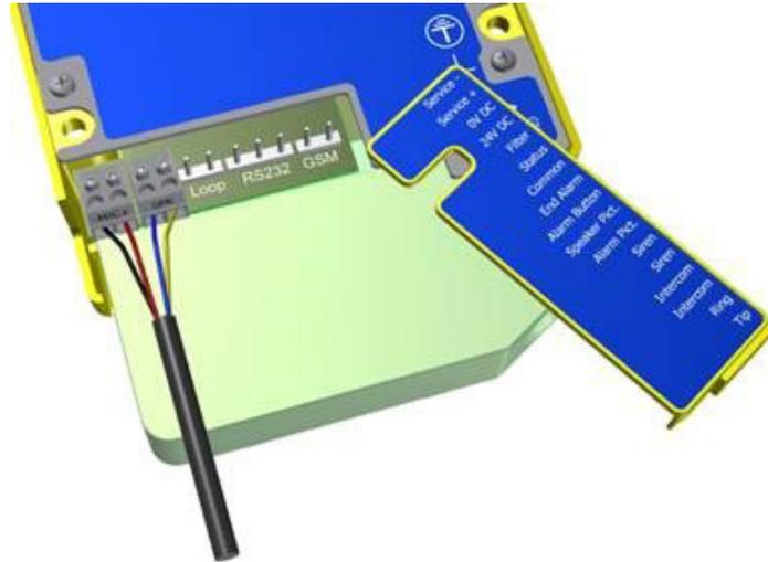
Les connexions suivantes sont requises pour le bornier de connexion 20 broches sur le haut du Memcom
