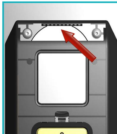
**6. Fixer la façade inox en utilisant la vis de sécurité fournie.**
