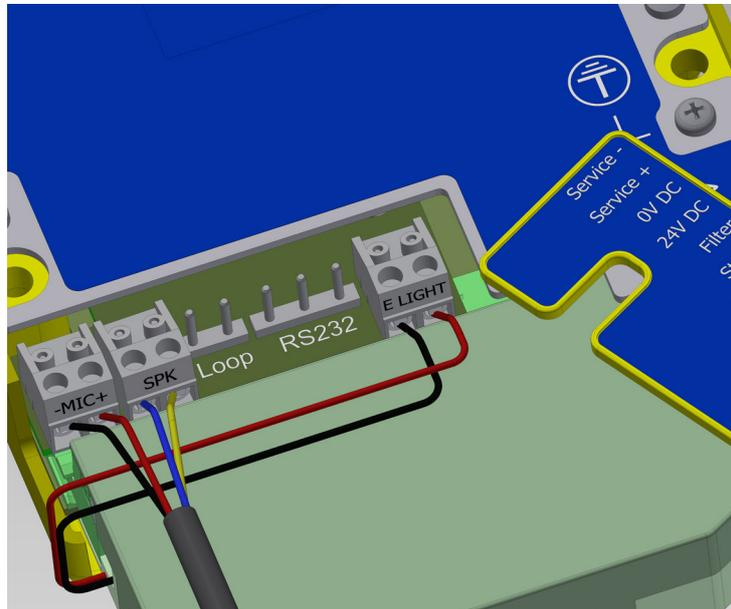
Les connexions suivantes sont nécessaires sur le bornier vert 20 broches situé sur la partie haute du Memcom.
