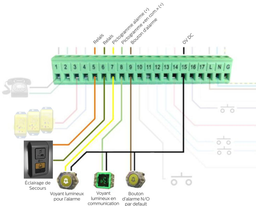
Ces connexions sont étiquetées sur chacun des fils connectés à l'accessoire. Veuillez noter qu'en utilisant le relais pour piloter l'éclairage de secours, vous ne pouvez plus utiliser le relais pour déclencher une sirène en appuyant sur le bouton d'appel.
