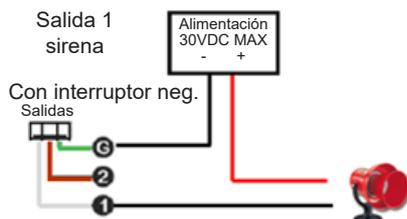
El voltaje de conmutación máximo es de 30 VCC y la corriente máxima para cada salida es de 150 mA.
