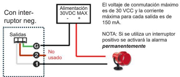
Se necesitará un cable de conexión AVIRE de 3 hilos.
