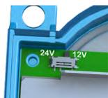
Es posible controlar pictogramas de 12Vdc o 24 Vdc. Para seleccionar la tensión adecuada para la aplicación, basta con mover el interruptor a la posición indicada.
