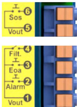
El pulsador de mantenimiento (SOS) lo utiliza, para pedir ayuda, el personal de mantenimiento en el caso de que quede atrapado en la instalación. Se genera una llamada a un número de teléfono específico como primera opción si se desea.
