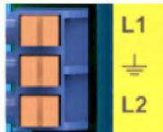
A este conector se cablea la línea telefónica exterior. Es muy importante conectar la toma de tierra al borne central de este conector. Esta conexión hace que el protector de transitorios y sobretensiones que pueden llegar al equipo, sobre todo en caso de tormentas eléctricas, queden debidamente filtrados. La ausencia de esta conexión puede provocar una avería en el equipo por sobretensiones y/o transitorios.
