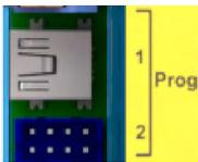
Al conector J9 se le puede conectar un programador externo con pantalla.
