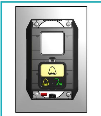
**5. Insérer la languette de la façade inox dans la rainure située en haut du module en plastique.**
