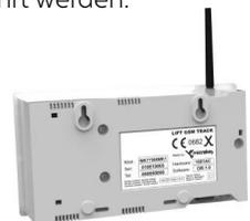
Um das Gerät zu fixieren, bohren Sie zwei Löcher in die Wand und setzen die mitgelieferten Dübel und Schrauben (POZI 4.5x35) ein. Dann hängen Sie das Universal Gateway an den beiden Befestigungspunkten auf.
