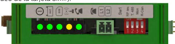
Puede comprobar el estado de la fuente de alimentación, la batería, la conexión, la cobertura o el circuito de interfaz de línea de abonado (SLIC) en cualquier momento consultando los indicadores LED (página 13).
