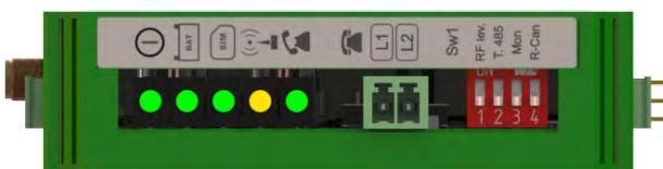
Sie können den Status der Stromversorgung, der Batterie, der Verbindung, der Netzabdeckung oder der Teilnehmeranschluss-Schnittstellenschaltung (SLIC) jederzeit anhand der LED-Anzeigen (Seite 13) überprüfen.
