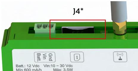
2. Conecte la antena de la DCP MRL a J2 y asegúrese de que está completamente atornillada.
