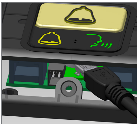
Der Anschluss des C100 PT befindet sich zwischen Alarmende- und Notrufknopf
