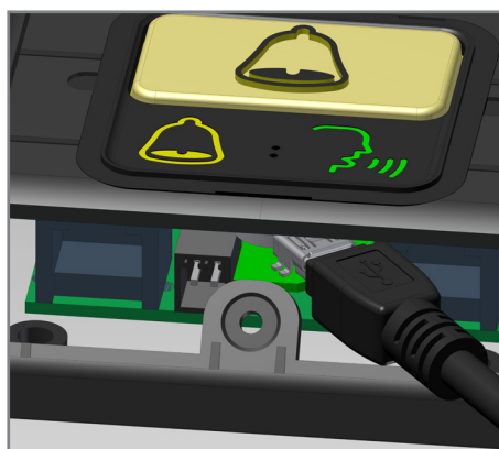
A porta de entrada para C100 PT está entre o final do alarme e o botão
