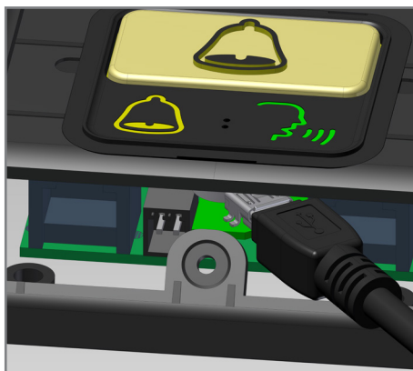
Le port d'entrée de l'outil de programmation C100PT est situé entre le fin d'alarme et le bouton d'appel.
